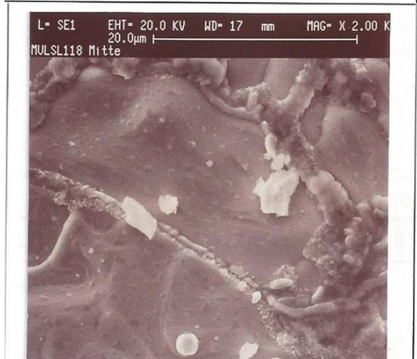
Abb.[12.8] Pillenoberfläche MUL\_SL 118 mit 15t verpreßt und nach Sinterschritt 3 aufgenommen
