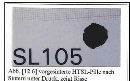
Abb. [12.6] vorgesinterte HTSL-Pille nach Sintern unter Druck, zeigt Risse
